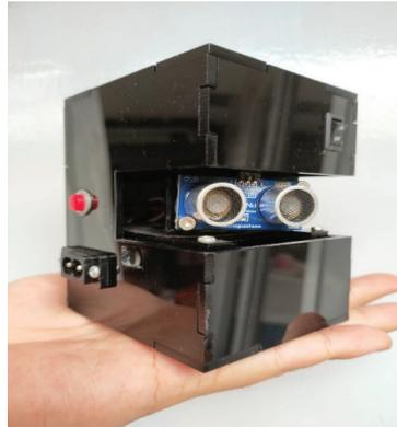
**Gambar 11. Unit microcontroller dengan sensor ultrasonic yang siap dipakai
