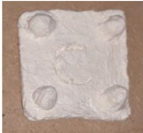
Gambar 6. Material Paperclay dengan Jenis Limbah Kertas HVS satu banding satu (Sumber: Dokumentasi Pribadi, 2018)
