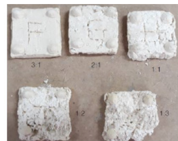
Gambar 4. Hasil Bakar Paperclay dengan Limbah Jenis Kertas Canson (Sumber: Dokumentasi Pribadi, 2018)
