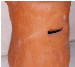
Gambar 1. Contoh Retak pada Produk Keramik karena Perbedaan Kelembapan (Sumber: Dokumentasi Pribadi, 2018)
