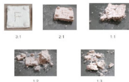
Gambar 5. Hasil Uji Kekuatan Paperclay dengan Limbah Jenis Kertas Canson (Sumber: Dokumentasi Pribadi, 2018)
