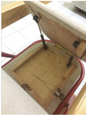
Gambar 2. Sistem Neumatik Pada Tempat Duduk (Sumber: Dokumentasi Pribadi, 2019)
