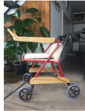
Gambar 5. Purwarupa Rollator (Sumber: Dokumentasi Pribadi, 2019)
