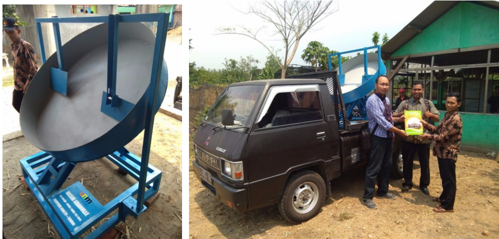
Gambar 3. Mesin Granulator kapasitas 75-100 kg/jam
