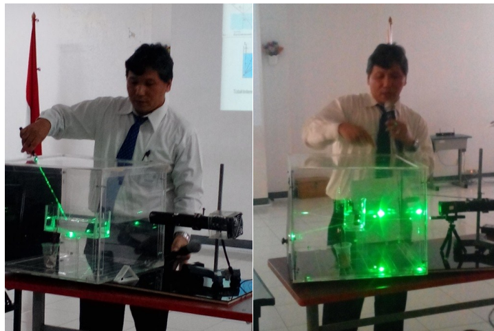
Gambar 5. Demonstrasi pembiasan sinar laser dalam air dalam kotak akrilik sederhana.
