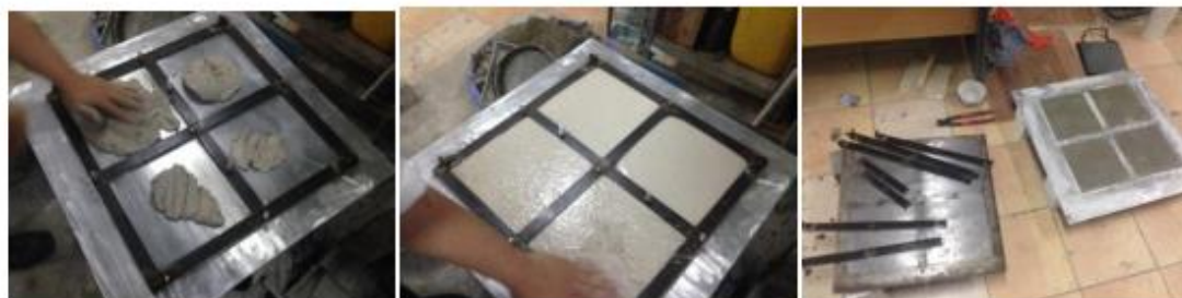
Gambar 2. Proses pembuatan ubin dengan teknik basah
