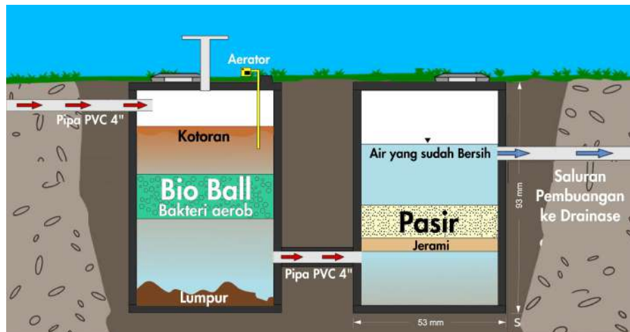
Gambar 2. Ilustrasi tangki bio-porta di dalam tanah.
