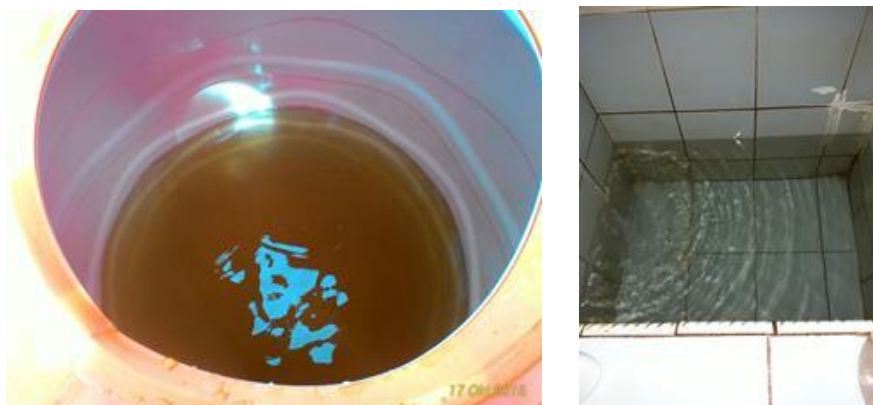
Gambar 9. Kondisi Air sebelum dan sesudah diolah dengan Rapid Sand Filter
