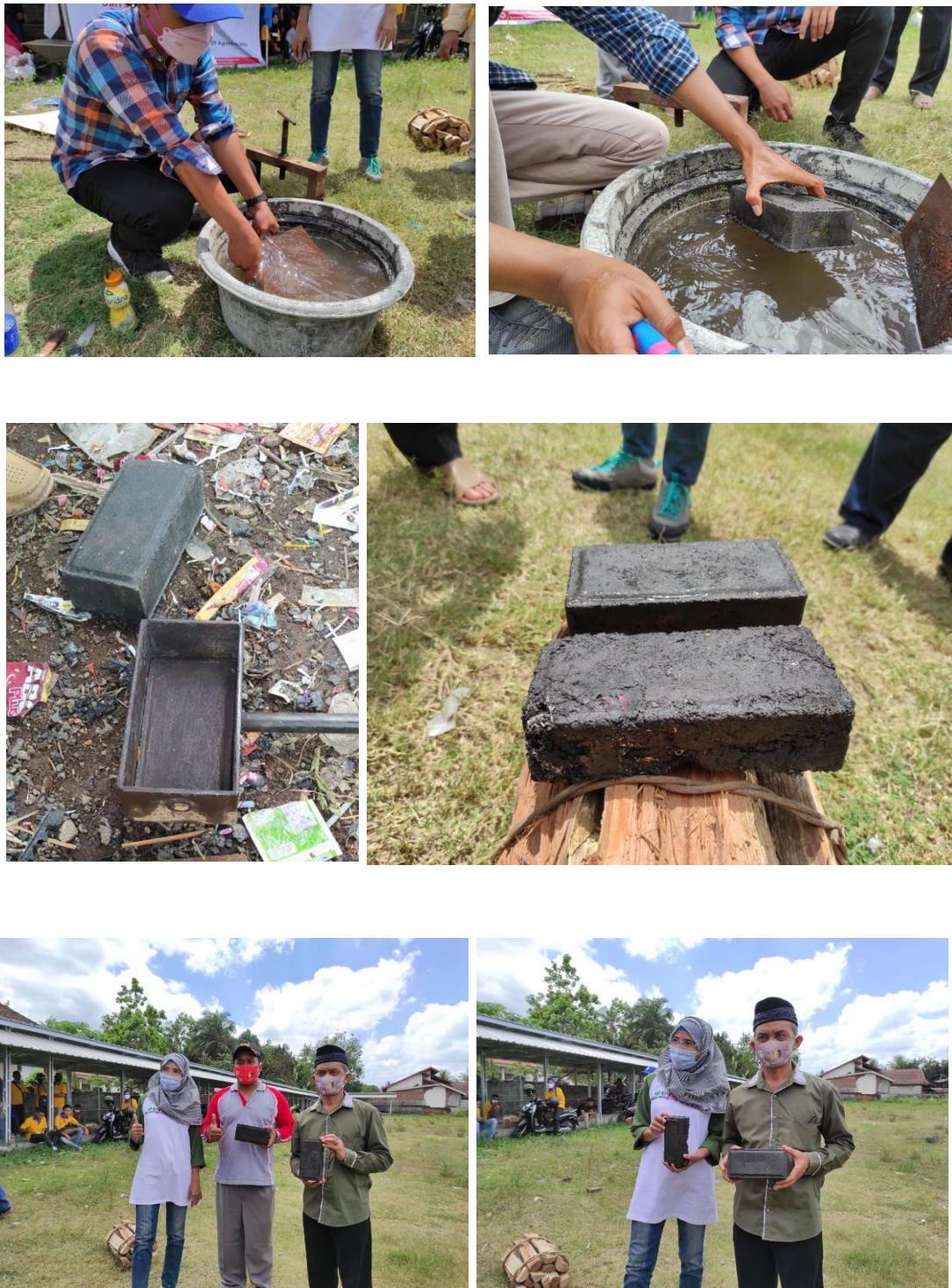
Gambar 6. Proses pendinginan paving block hingga mengeras
