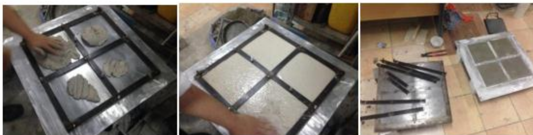
Gambar 2. Proses pembuatan ubin dengan teknik basah
