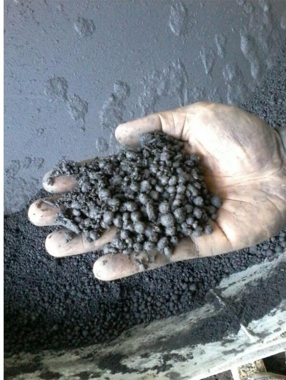
Gambar 6. Hasil Mesin Granulator berupa butiran pupuk
