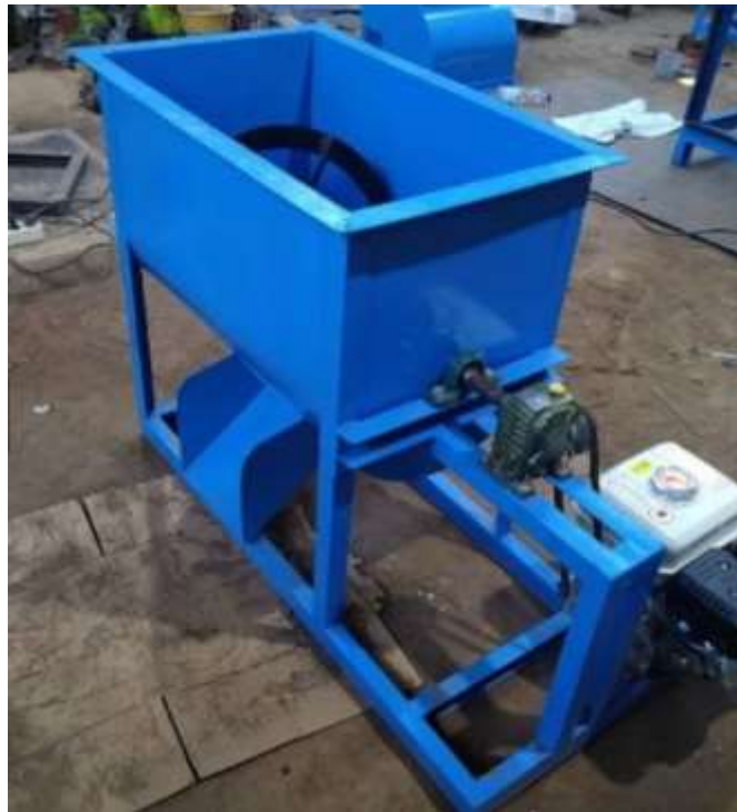
Gambar 7. Gambar alat pencampur pakan burung puyuh.
