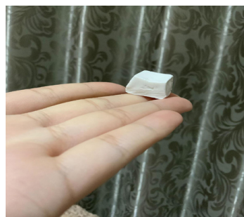
Gambar 4 Prototype keycaps berbahan daur ulang plastik HDPE Generasi pertama (Sumber: Agustin,2022)
