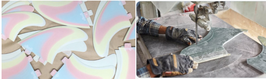
Gambar 3 Fin yang diproduksi secara manual oleh Alkali Fins (Australia) (Sumber: https://alkalifins.com )
