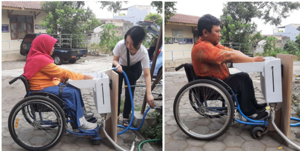
Gambar 1 Uji Coba Produk Akhir Desain Tempat Cuci Inklusif bagi Pengguna Kursi Roda. (Sumber: Angelica, Guspara & Purwanto, 2023)
