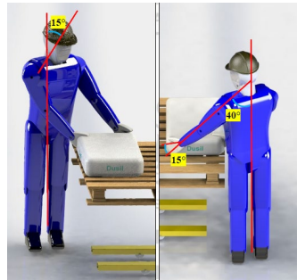
Gambar 7 Pengangkatan karung aditif dengan hydraulic stacker
