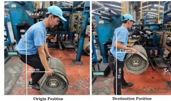
Gambar 7. Ilustrasi pengangkatan ply secara manual
