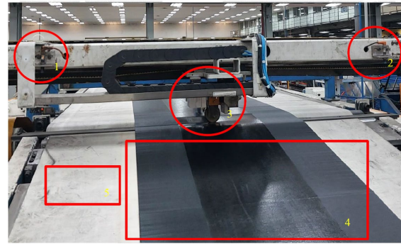
Gambar 2. Bagian-bagian Mesin Building pada Area Cutter Body Ply
