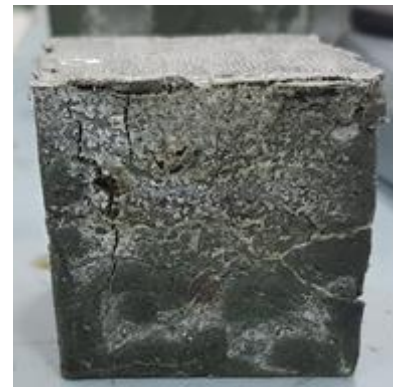
Gambar 3. Keruntuhan benda uji PP 50:50
