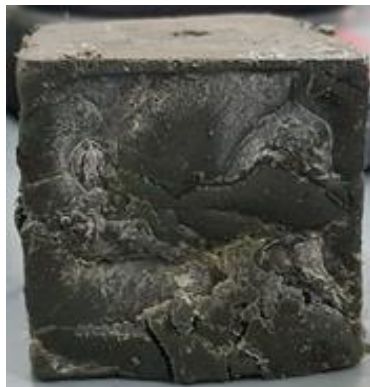
Gambar 1. Keruntuhan benda uji P 100%
