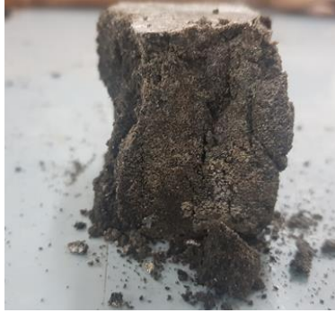
Gambar 5. Keruntuhan benda uji PP 25:75
