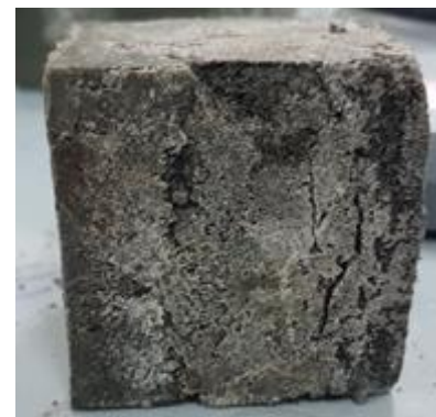
Gambar 4. Keruntuhan benda uji PP 33,33:66,67
