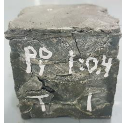
Gambar 2. Keruntuhan benda uji PP 70:30
