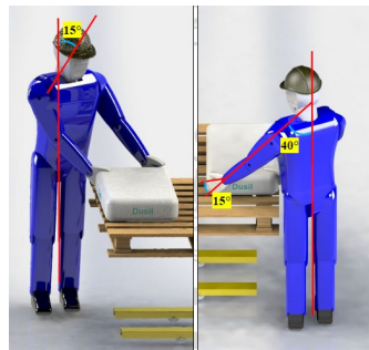
Gambar 7 Pengangkatan karung aditif dengan hydraulic stacker
