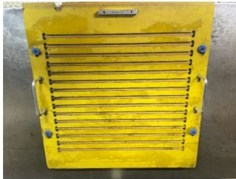
Gambar 5. Alat Bantu Peletakan Rubber
